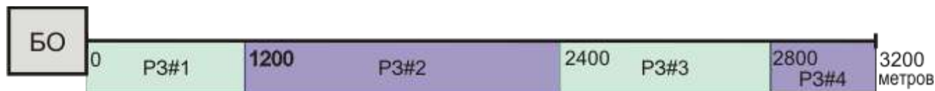
Рисунок 1.3 – Пример установки релейных зон по длине ЧЭ.
