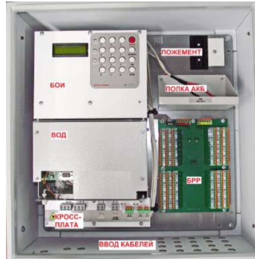
Рисунок 1.6 – Блок обработки ИП132-1-Р-БО «Елань». Расположение блоков. Плата источника питания ИПМ находится под БОИ.
