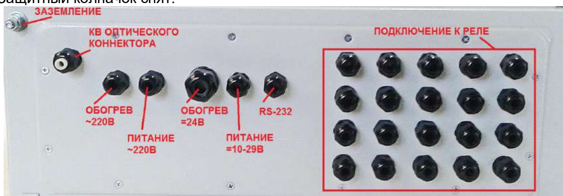
Рисунок 1.9 – Нижняя стенка блока обработки ИП132-1-Р «Елань». Расположение и назначение кабельных вводов (КВ).
