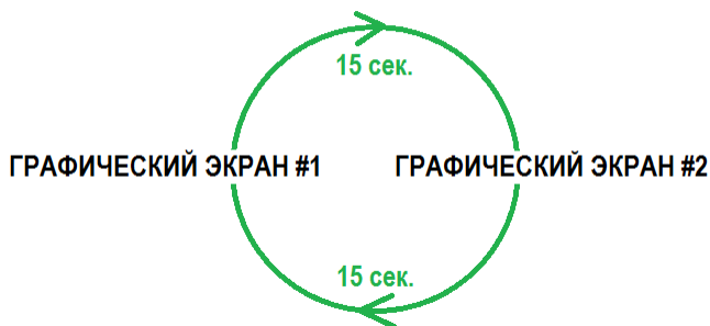
Рисунок 28 – Циклическое переключение 2-х экранов.
